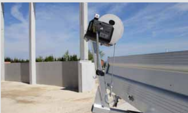
Seilwinde auf geschweißtem Windenbock
