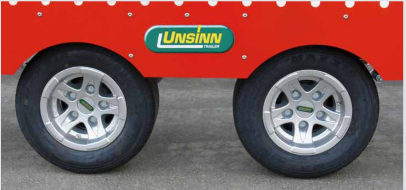
10 Zoll Bereifung für eine niedrige Ladehöhe
