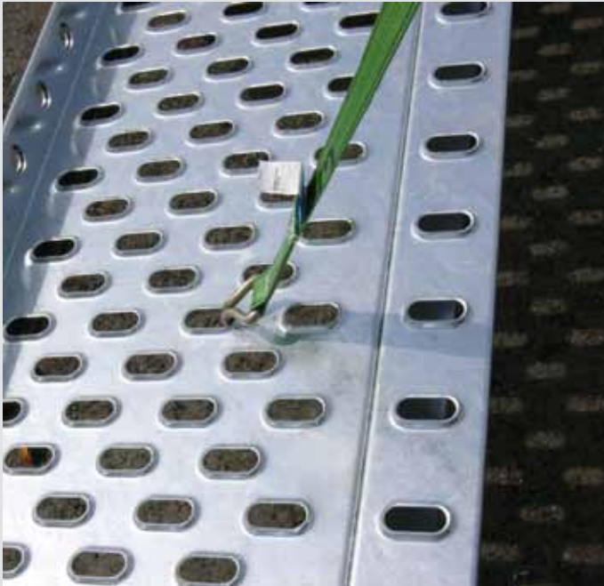
zusätzliche Verzurrmöglichkeiten in der Ladefläche
