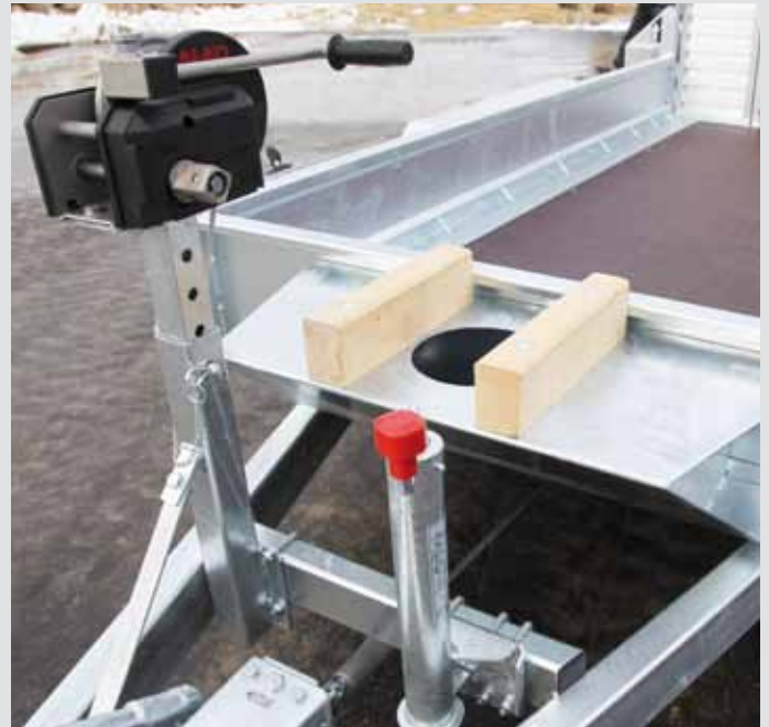
Baggerarmauflage, Windenbock mit Handseilwinde
