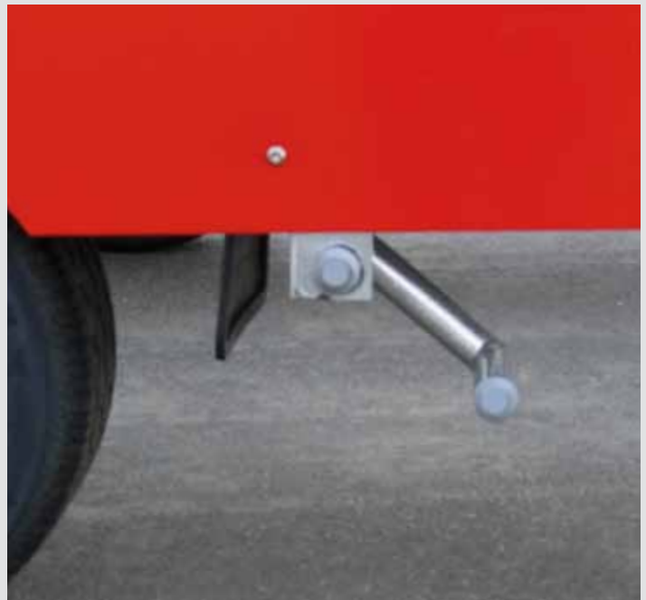
Hebel zum Entriegeln der Auffahrampen
