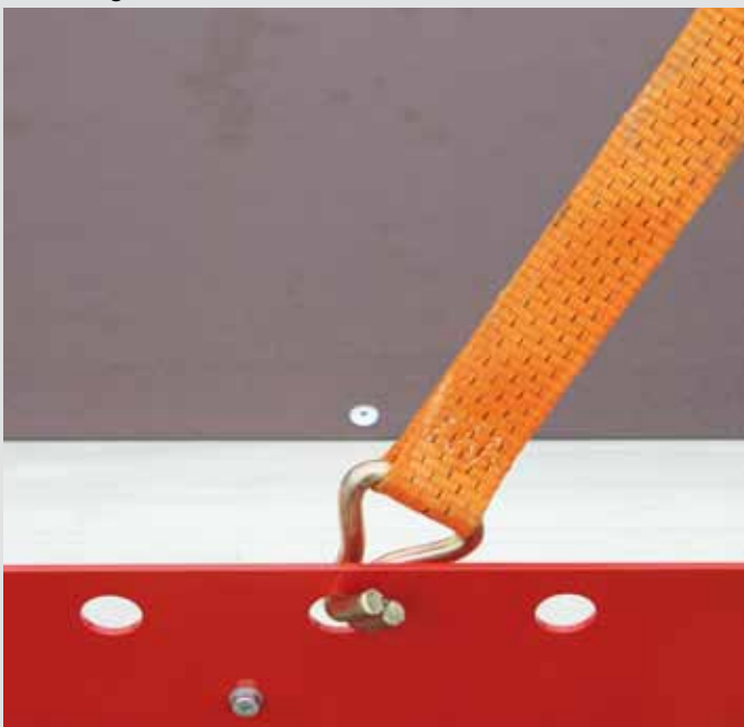
Zurpunkte in der Seitenreling mit 400 kg belastbar
