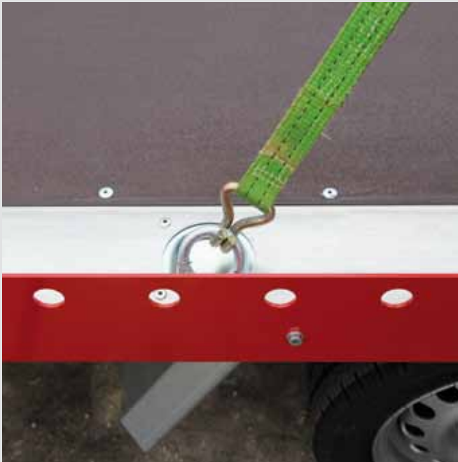
Zurrpunkte in der Ladefläche mit 600 kg belastbar
