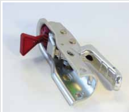
Kugelkupplung mit Safety-Ball
