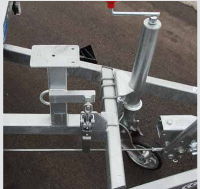
Windenbock mit Sicherungshebel
