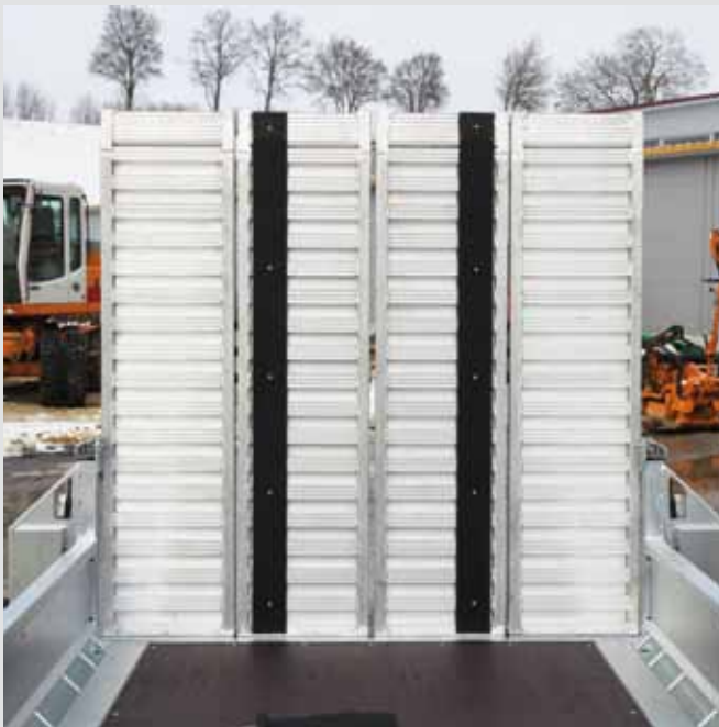
durchgehende Auffahrampen mit Gummiauflage
