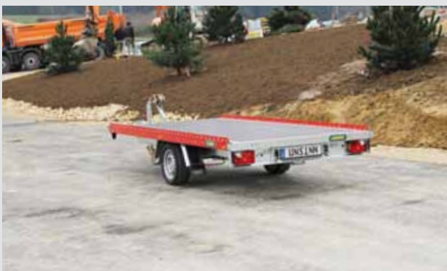
Einachsenausführung bis 1265 kg Nutzlast
