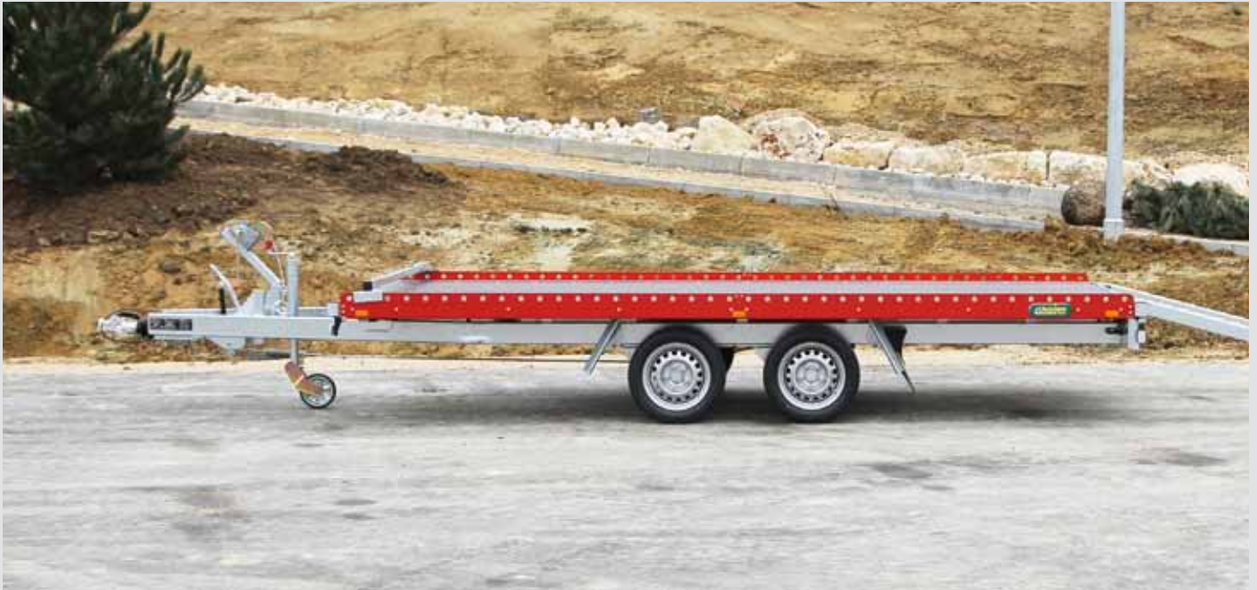
Reling mit Zurrpunkten für flexible Ladungssicherung mit 400 kg pro Zurrpunkt belastbar
