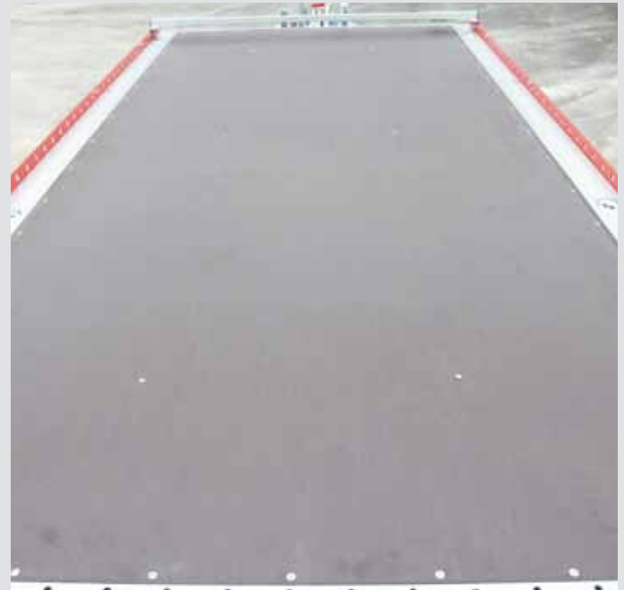
durchgehende Bodenplatte ohne Stöße
