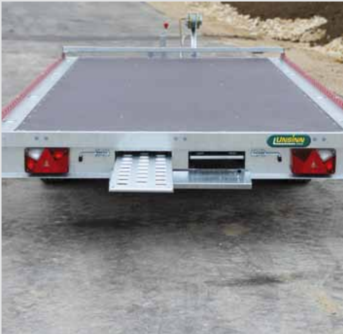
Halterungen für Auffahrschienen unter der Ladefläche
