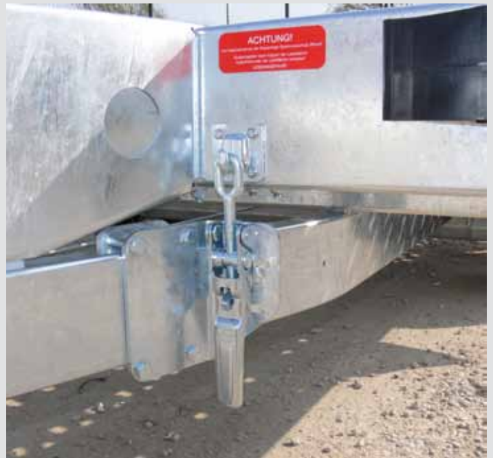
Sicherungsverschluss der Abklippfunktion
