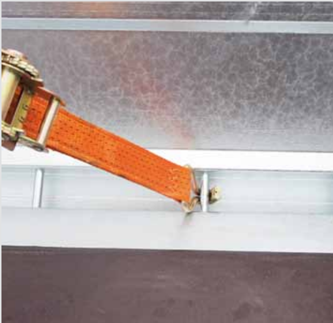
Zurrpunkt mit 2000 kg Zugkraft
