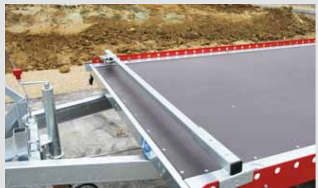
Radstopper kann variabel angebracht werden
