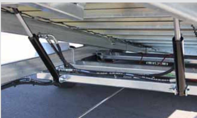
Doppelte Hydraulik für gleichmäßiges Abkippen
