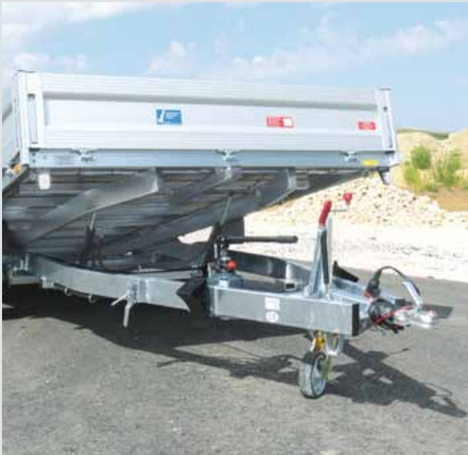
verschweißter und feuerverzinkter Stahlrahmen
