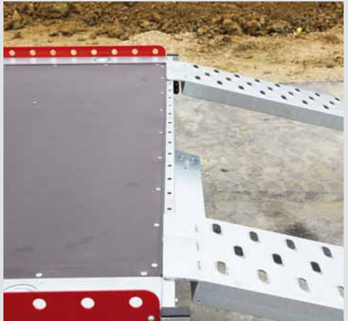
Lochleiste für Auffahrschienen als Abrutschsicherung
