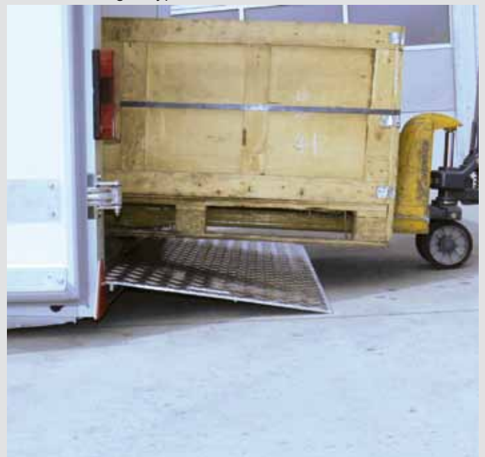
flacher Auffahrwinkel für müheloses Beladen
