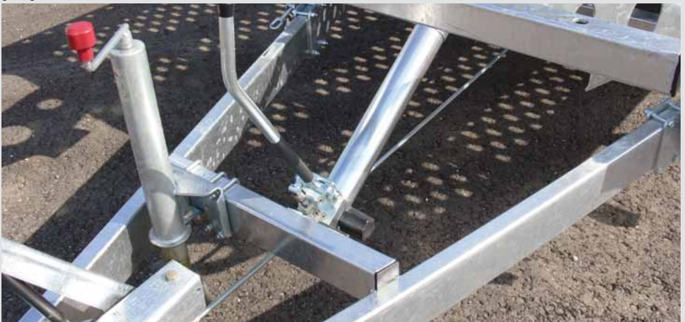
Hydraulik mit Handpumpe
