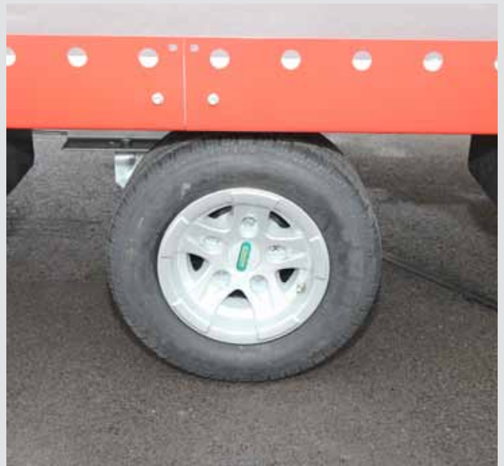
10 Zoll Bereifung für eine niedrige Beladehöhe
