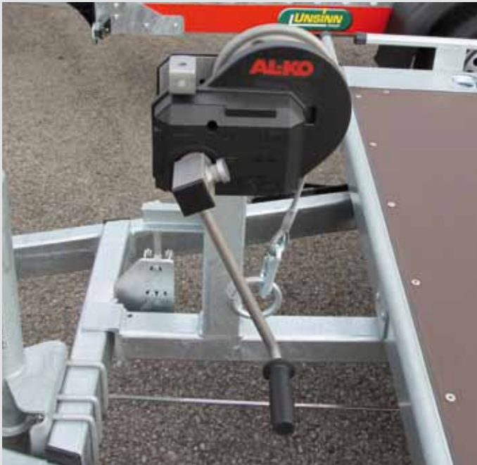
Seilwinde auf Windenbock montiert
