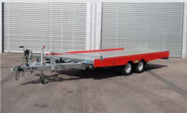
verschweißter und feuerverzinkter Stahlrahmen
