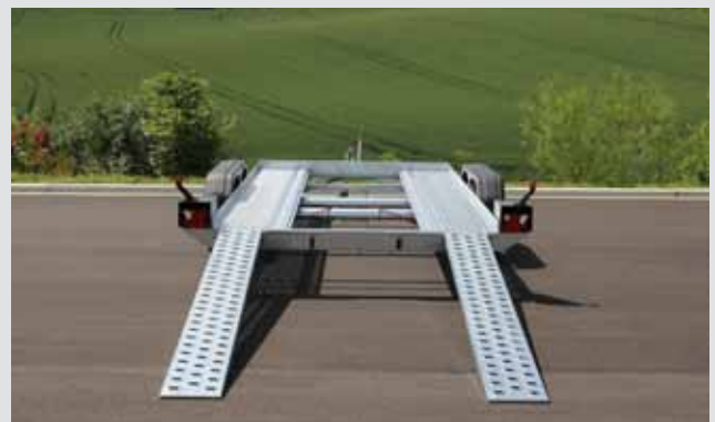
Auffahrrampen verankert zum beladen
