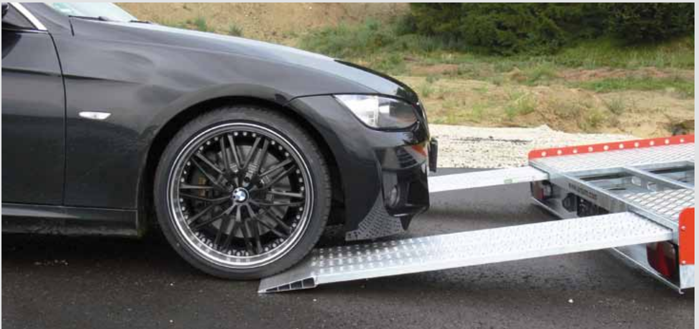
geringer Auffahrwinkel für Fahrzeuge mit wenig Bodenfreiheit
