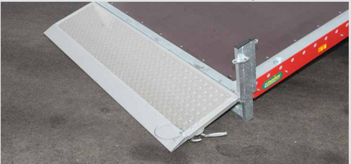
durchgehende Auffahrklappe mit rutschhemmendem Riffelblech
