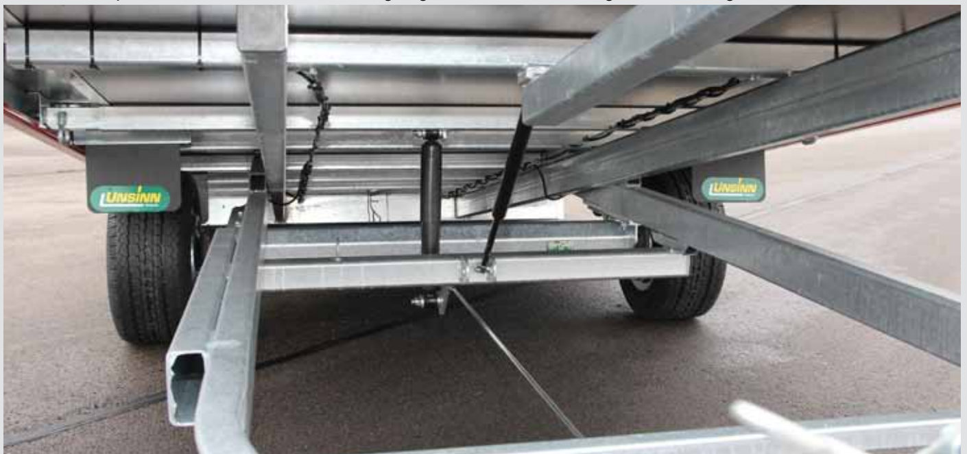
Gasfeder als Hubhilfe
