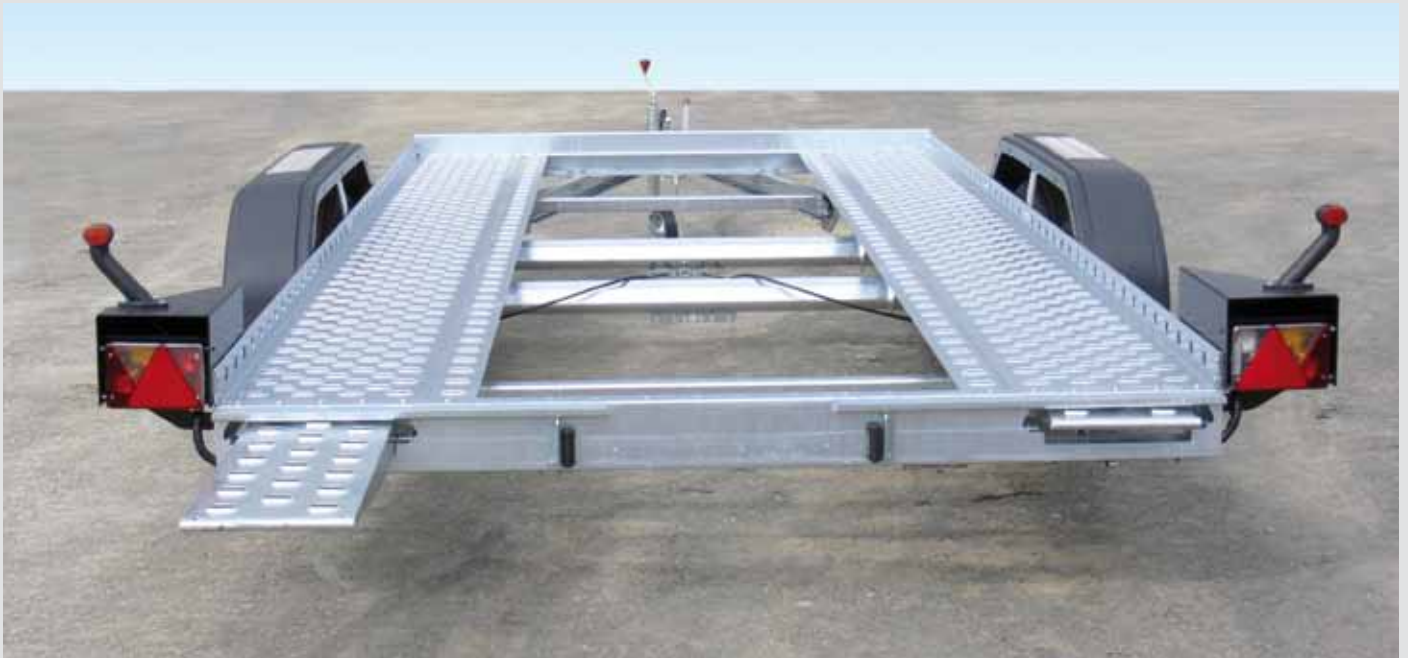
Auffahrampen unter der Ladefläche
