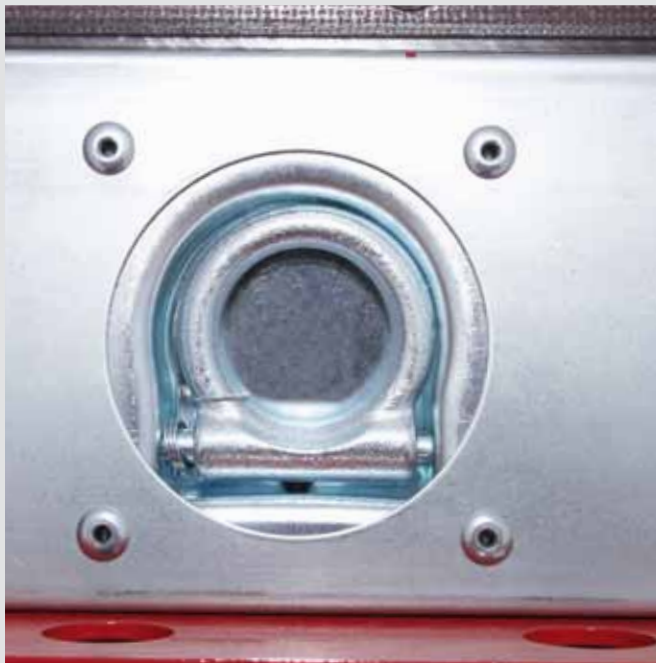
versenkte Zurpunkte in der Ladefläche mit 600 kg Zugkraft
