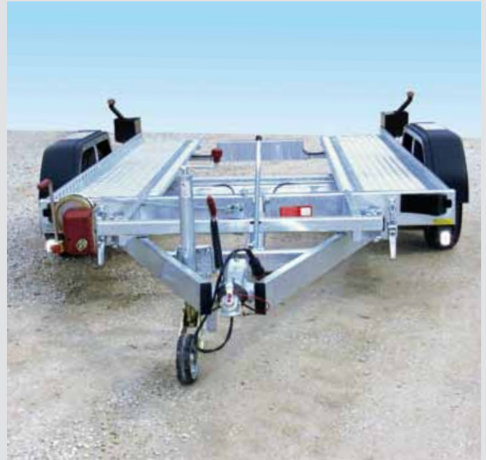
Seilwinde mit verstellbarer Umlenkrolle für leichtes Beladen
