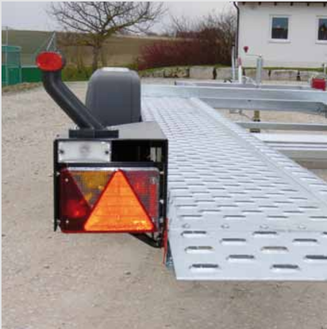
Leuchten geschützt montiert
