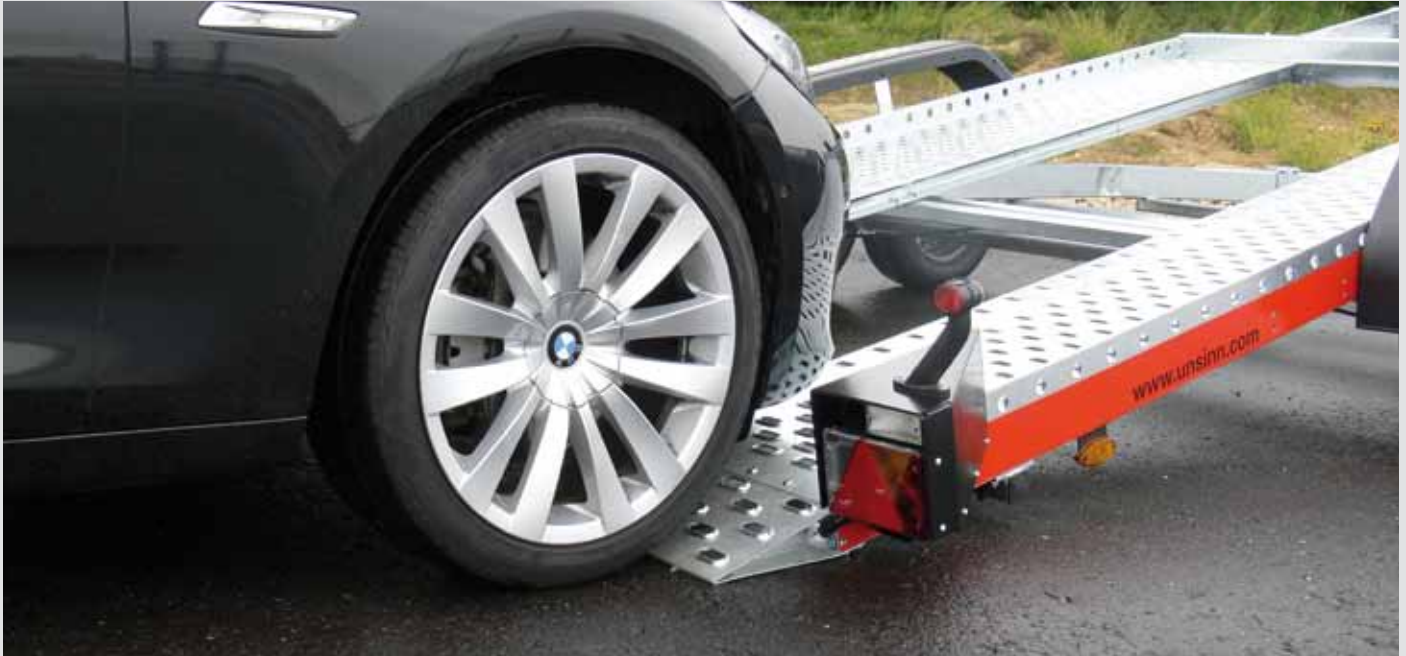
geringer Auffahrwinkel für Fahrzeuge mit wenig Bodenfreiheit
