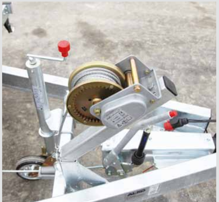
Handseilwinde mit 900 kg Zugkraft
